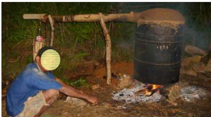
**Figure 27 : Dispositif de distillation artisanale du *toaka gash***
